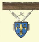
Sapendo che lo stemma ha una massa di 13,6 kg, determina l'allungamento delle due molle quando il sistema è in equilibrio. Se una delle molle si rompe e lo stemma resta fissato a una sola delle due, qual è la variazione percentuale dell'allungamento della molla che sostiene lo stemma?
