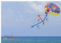
La risultante di due o più forze può quindi essere determinata con la regola del parallelogramma o il metodo punta-coda. Per esempio, se facciamo parasailing come mostrato nella figura a lato, la forza  $\vec{F}_1$  di trazione del cavo agganciato al motoscafo e la forza  $\vec{F}_2$  di resistenza del paracadute producono una forza risultante  $\vec{F} = \vec{F}_1 + \vec{F}_2$  che ci permette di vincere il nostro peso e sollevarci in aria sorvolando il mare.
