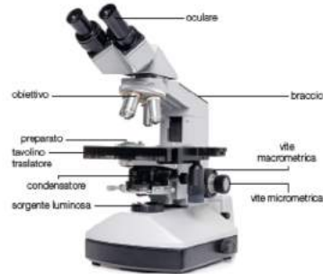
Figura 5 Microscopio ottico composto. Questo strumento ha un potere di risoluzione di circa 0,2 \mu\text{m} , cioè 1000 volte superiore all'occhio umano.
